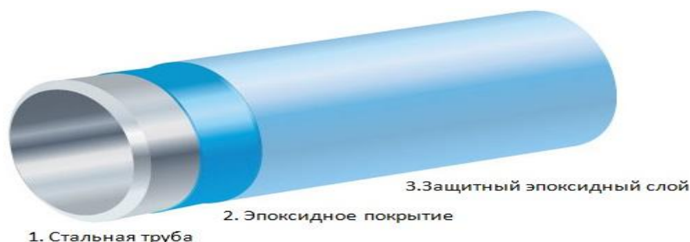
Рисунок 11 – Исполнение изоляции на основе двухслойного эпоксидного покрытия
