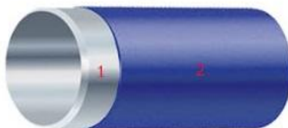
1. Стальная труба 2. Эпоксидное покрытие
