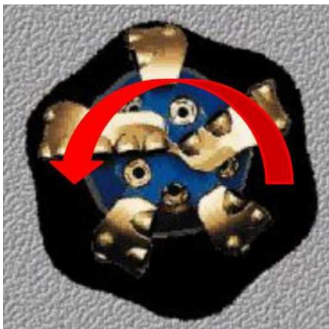
Рисунок 2.2 Многоугольное сечение скважины, образованное завихрением долота
