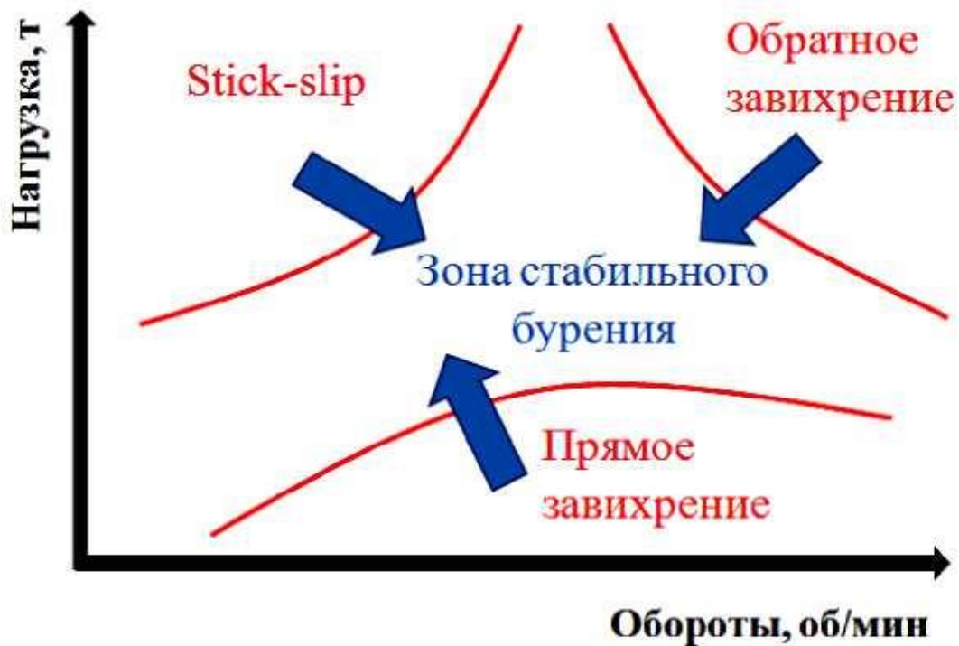
Рисунок 2.3 Схема поддержания режима бурения в зоне стабильности
