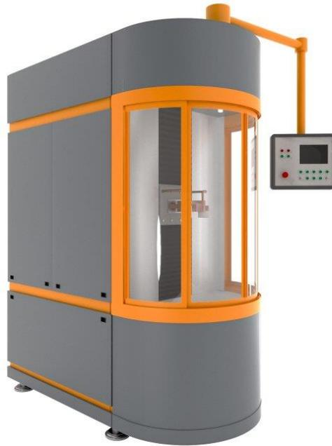
*Рис. 1.1 Закалочный станок HM-1000.*
