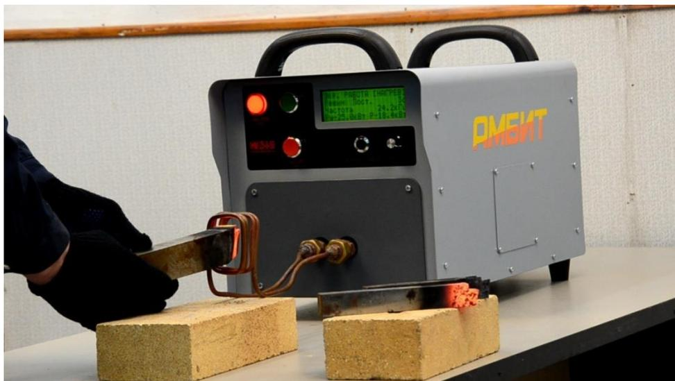
*Рис. 1.2 Установка для индукционного нагрева.*
