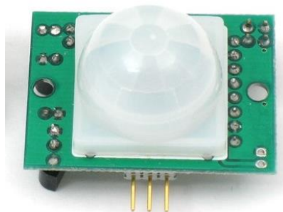
Рисунок 7 - Пирозлектрический инфракрасный (PIR) датчик движения
