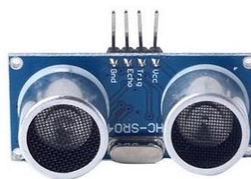
Рисунок 4 - Направленный датчик HC-SR04
