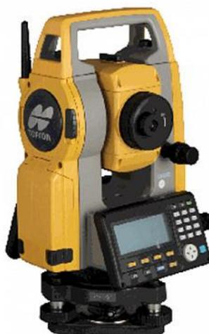
Рисунок 5 – Тахеометр Topcon ES-103
