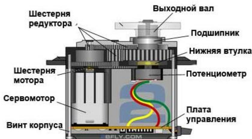
Рисунок 4 – Устройство сервопривода
