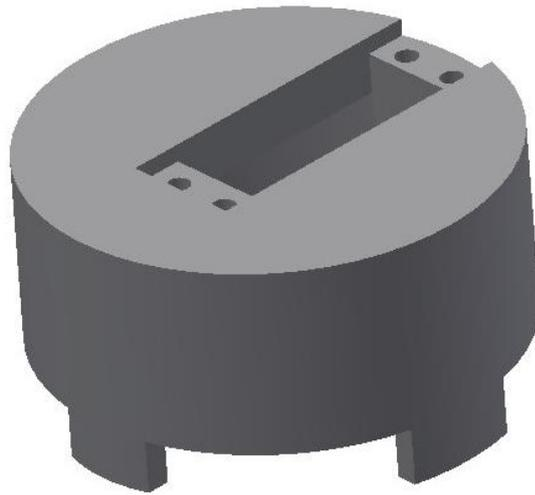
Рисунок 15 - 3д модель платформы для первого сервопривода
