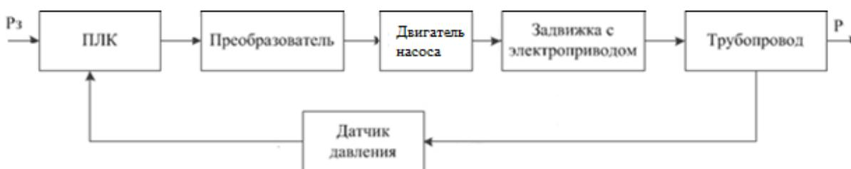
Рисунок 30 – ФС системы поддержания давления в трубопроводе
