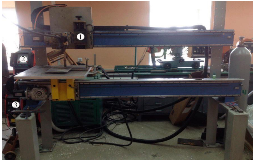
Рисунок 10 Автоматическая сварочная установка MECOME WP 1500: 1 – Установка автоматической сварки; 2 – Источник питания Lorch;
