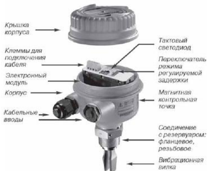
Рисунок 11 – Конструкция сигнализатора уровня
