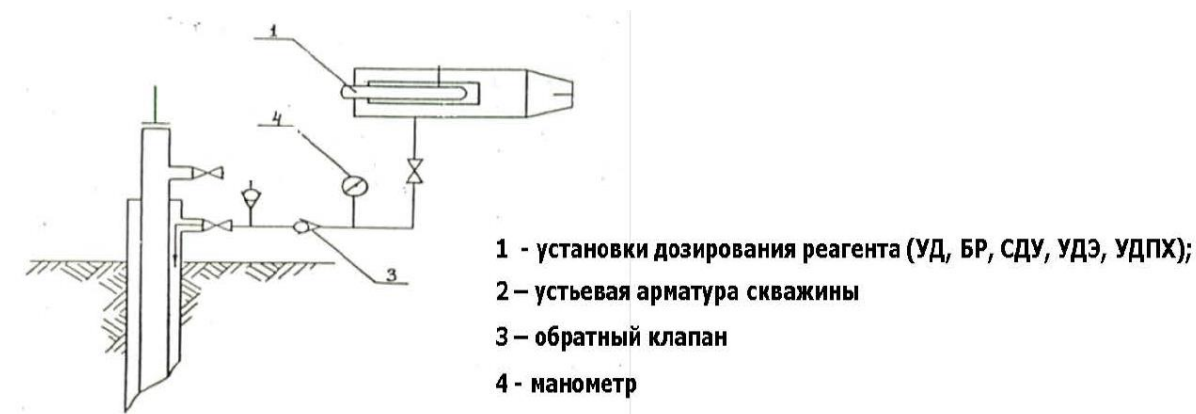
Рисунок 2.5 – Обвязка дозирующего устройства для подачи реагента в затрубное пространство скважины
