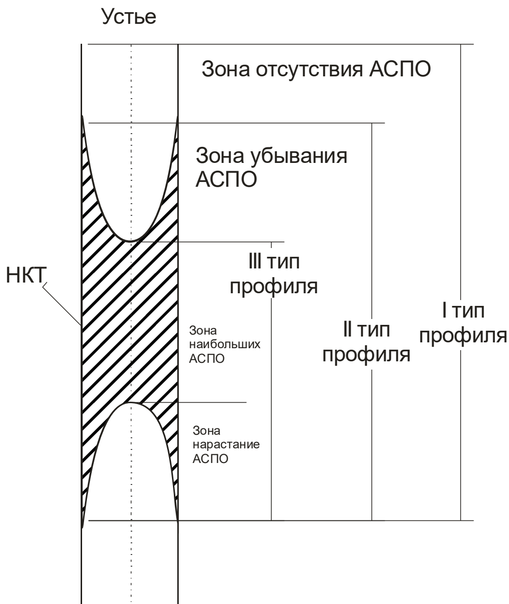
Рисунок 2.2 – Свободный профиль отложений асфальтосмолопарафиновых веществ.
