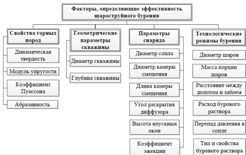
Рисунок 1.2 – Классификация факторов, определяющих эффективность шароструйного бурения
