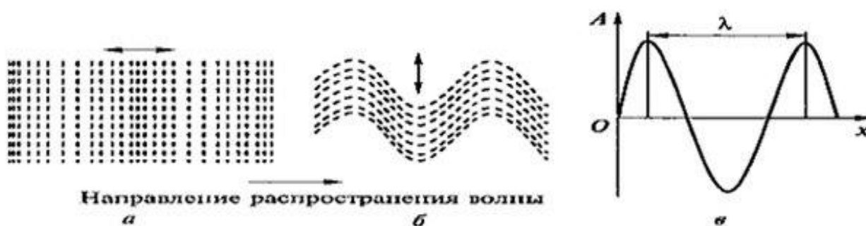
Рисунок 21 - Акустические упругие волны в среде: а - продольные; б - поперечные; в - графическое изображение волны; стрелки "→" и "↑" указывают направление колебания частиц
