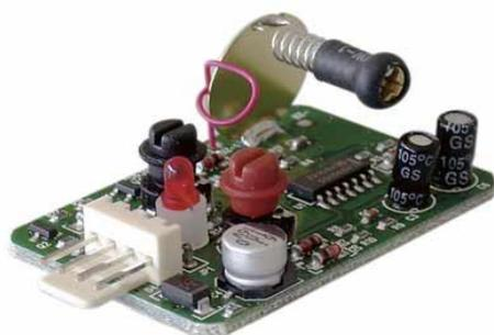
Рис.4. Датчик удара
