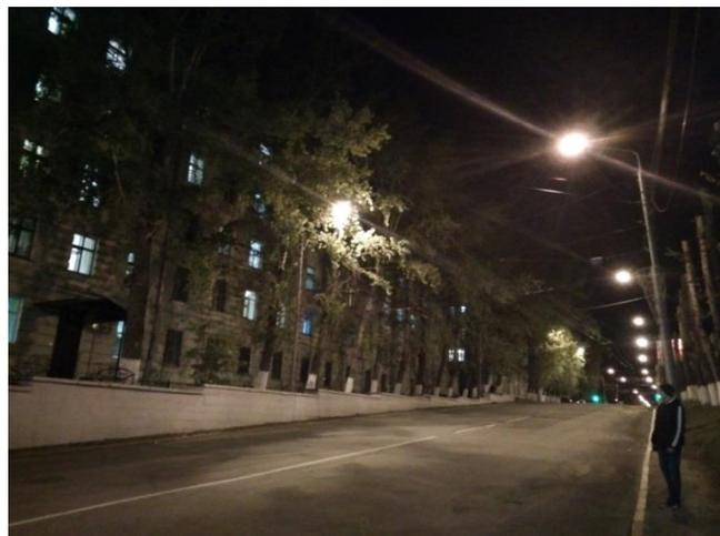
Рисунок 3.4 затенение СП кроной дерева
