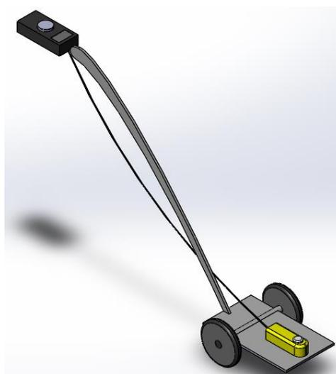
Рисунок 1.2. «Тележка-перевозка» для измерения освещенности
