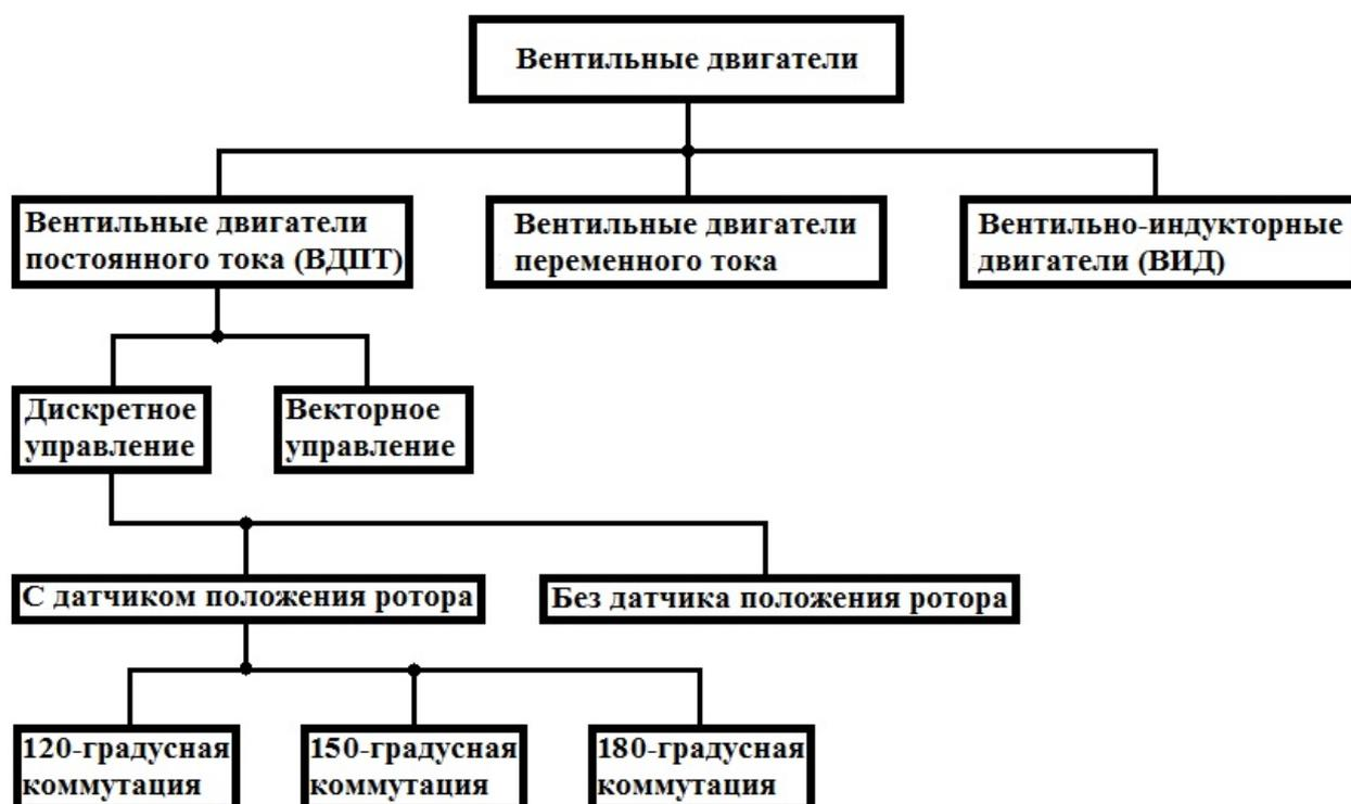
Рисунок 2 – Классификация вентильных двигателей
