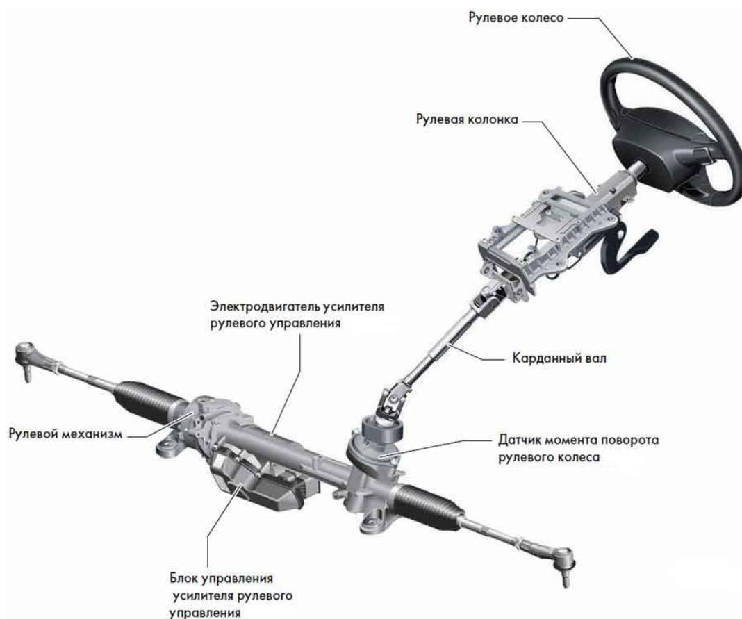
Рисунок 23 – Принципиальная схема ЭУР с параллельным приводом
