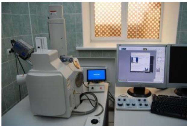
Рисунок 10 - Сканирующий электронный микроскоп Hitachi S3400N с приставкой для микроанализа Bruker XFlash 4010
