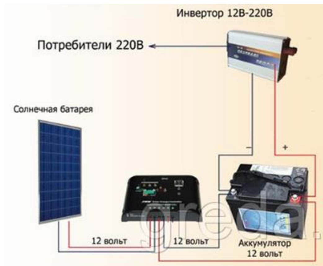
Рисунок 2, Принципиальная схема электроснабжения автономного объекта
