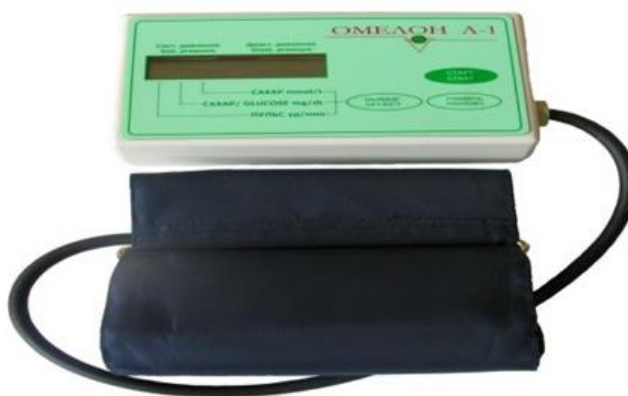
Рисунок 2 – Неинвазивный глюкометр Омелон А-1 [9]
