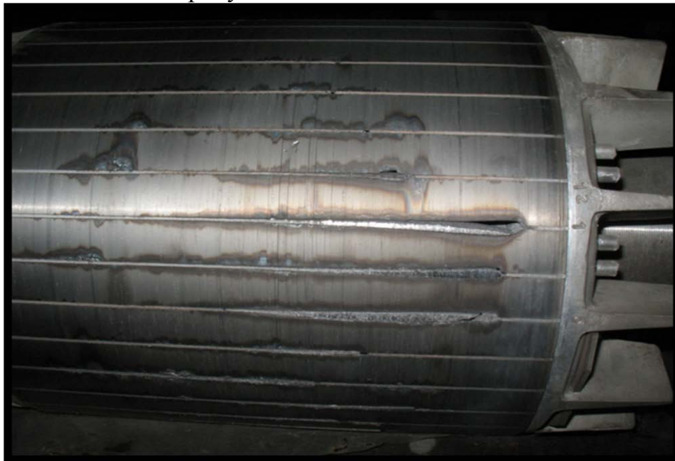
Рисунок 2 – Обрыв стержня в процессе остывания
