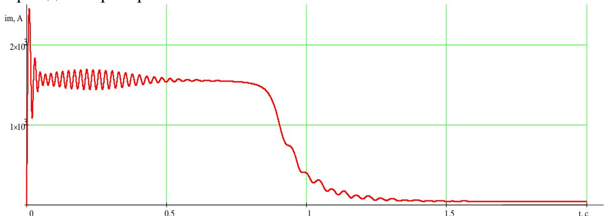
Рисунок 19 – График переходного процесса модуля результирующего вектора тока статора при пуске АД на холостом ходу без повреждений ротора
