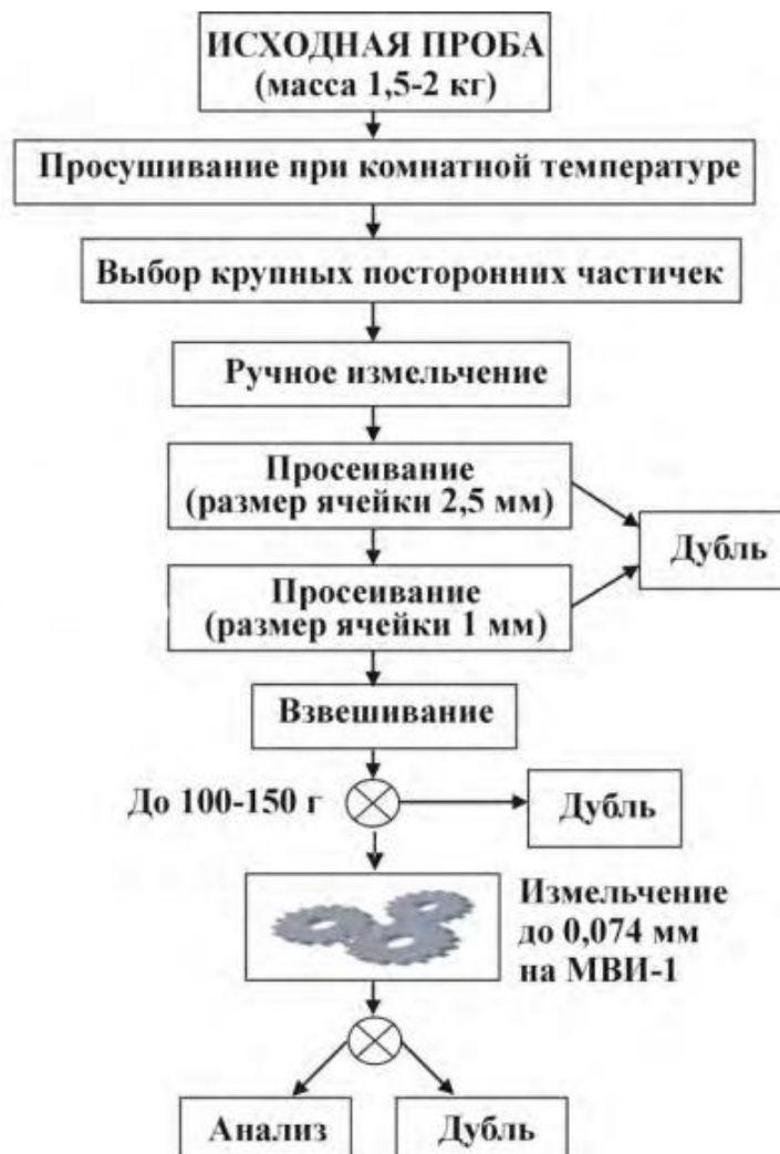
Рисунок 5 - Пробоподготовка почвы для последующего анализа [4]
