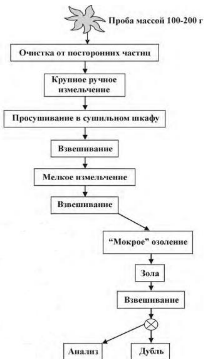
Рисунок 7 - Пробоподготовка листьев берёзы для последующего анализа [4]
