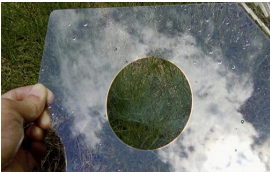
Рисунок 54 – Стекло, демонстрирующее работу антибликового покрытия
