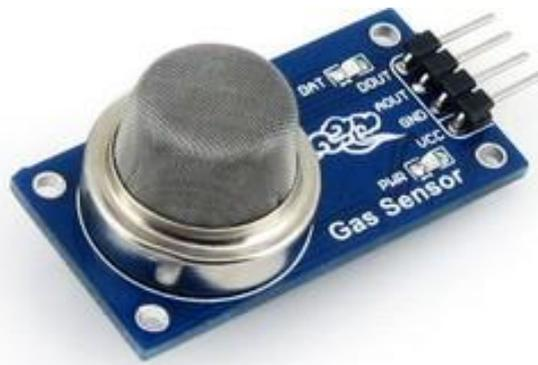
Рис 9. Модуль датчика газа MQ-135
