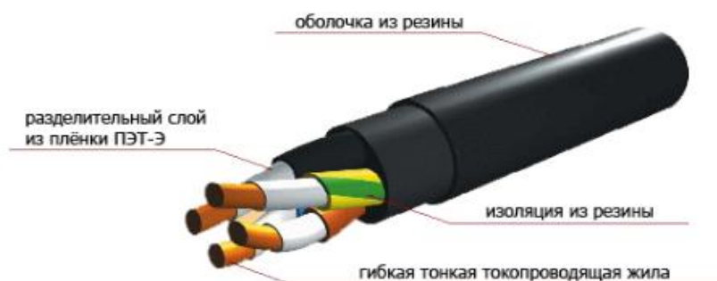
Рисунок 1 – Конструкция силового кабеля КГН
