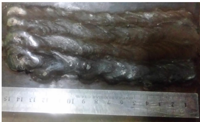
Рисунок 33. Наплавленный слой с большим шагом перекрытия двумя электродами.
