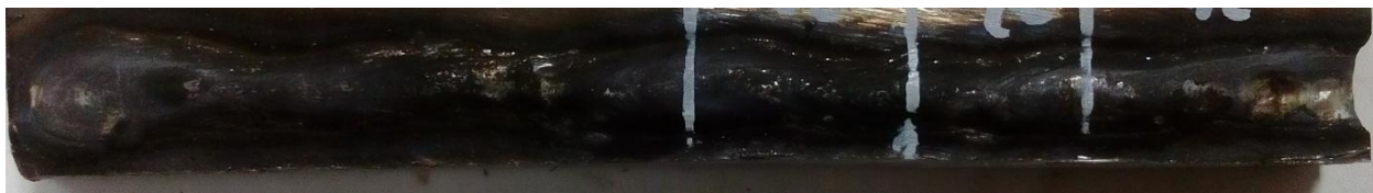
Рисунок 21. Наплавка без колебаний под «прямым углом» со скоростью 32,4м/ч.
