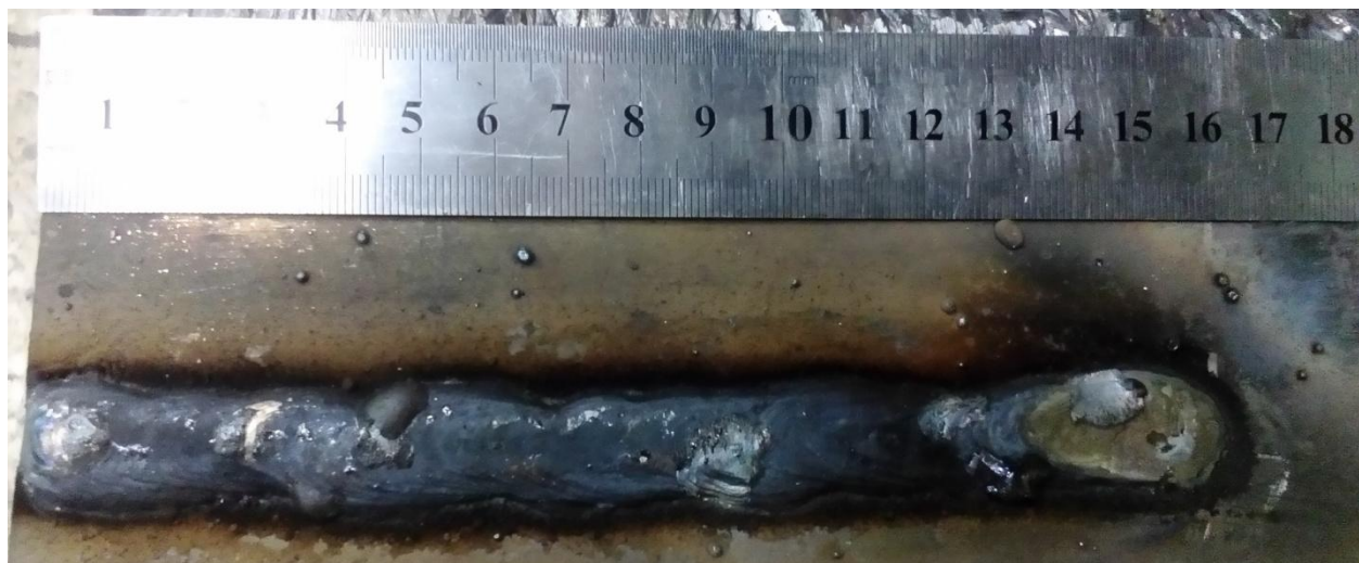
Рисунок 29. Наплавка без колебательных движений со скоростью 9м/ч «углом назад» двумя электродами.
