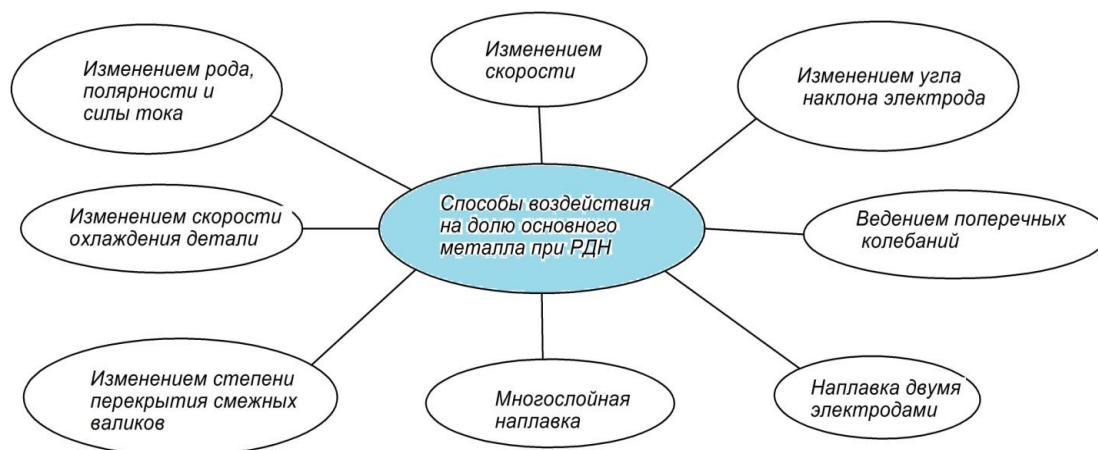
Рисунок 5. Способы воздействия на долю основного металла при РДН.
