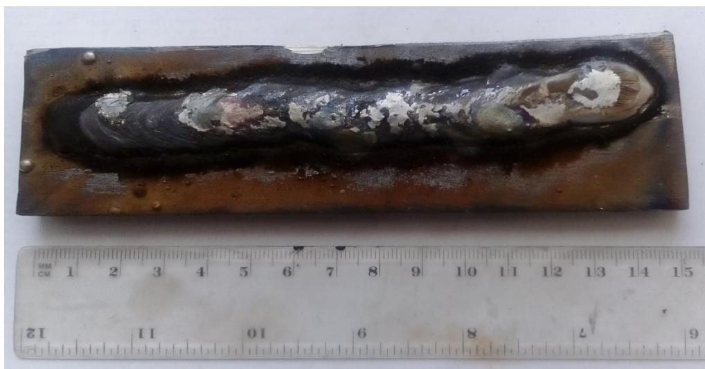
Рисунок 25. Наплавка круговыми движениями со скоростью 10,8м/ч.
