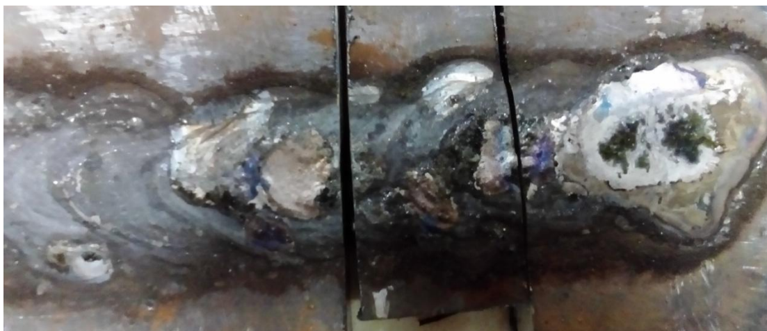
Рисунок 31. Наплавка без колебательных движений со скоростью 5,8м/ч «углом назад» тремя электродами.
