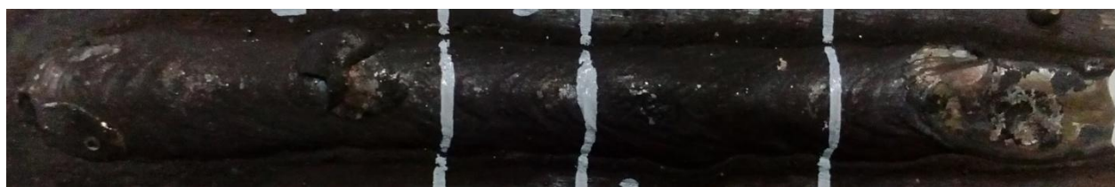
Рисунок 19. Наплавка без колебаний «углом назад» со скоростью 9,1м/ч .
