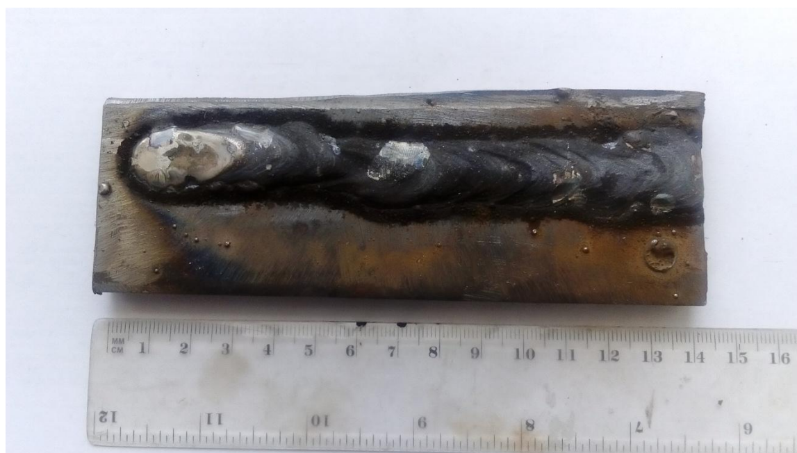
Рисунок 27. Наплавка треугольными движениями со скоростью 8,6м/ч.
