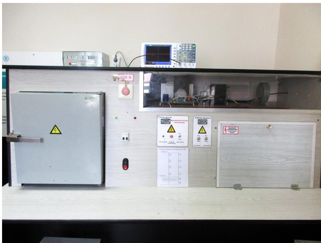
Рис. 10. Учебно-лабораторный стенд для проведения короностойкости кабельных изделий при питании ВЧ модулированного напряжения.
