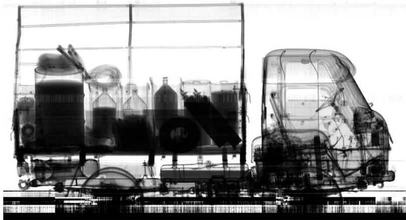
Рисунок 1- Изображение объекта, полученное с помощью радиационного контроля
