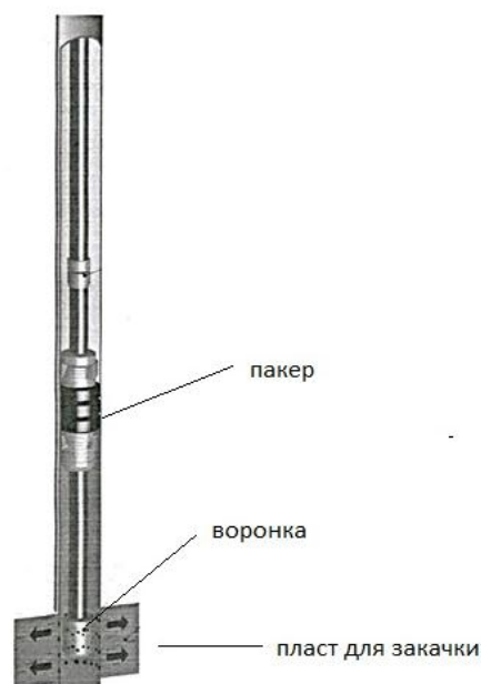
Рисунок 17 – Схема подземного оборудования нагнетательной скважины
