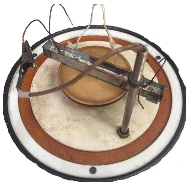
Рисунок 21. Испытательная ячейка термошкафа.
