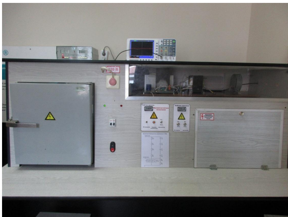
Рис. 14. Учебно-лабораторный стенд для определения короностойкости кабельных изделий.
