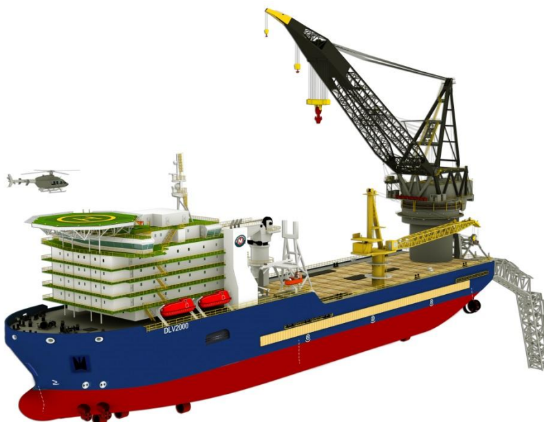
Рисунок 1.4 - Трубоукладочное судно DLV2000 [7]
