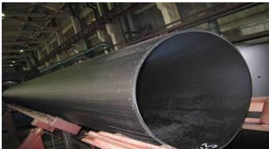
Рисунок 1.42 – Полимерная оболочка толщиной 8 мм [12]
