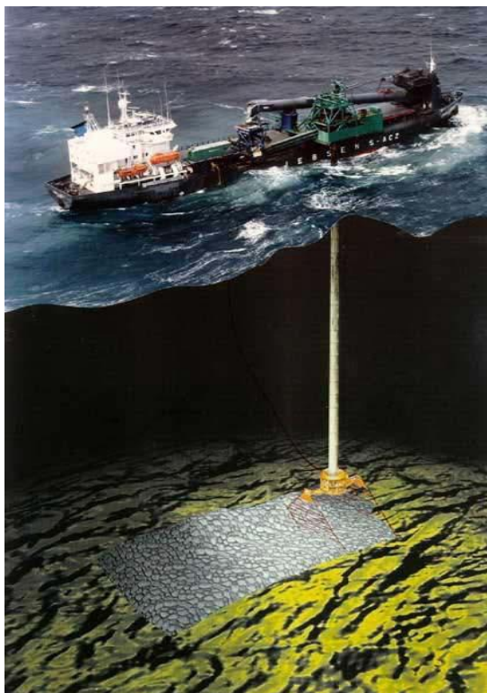
Рисунок 1.3-8 - Судно с гибкой спускной трубой, распределяющей каменный материал вокруг трубопровода
