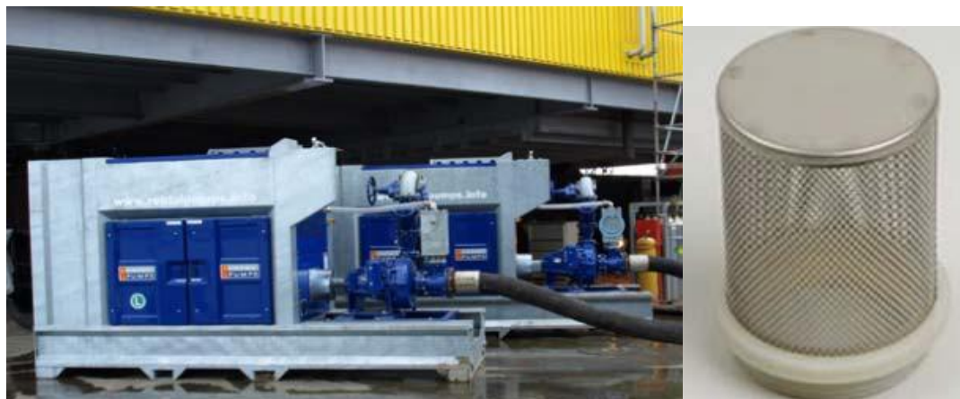
Рисунок 1.3-19 - Насосное оборудование и защитные устройства для забора воды на гидроиспытания
