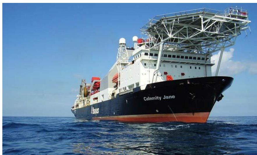
Рисунок 1.3-3 Судно обеспечения для срезки/выравнивания участков морского дна типа «Calamity Jane»
