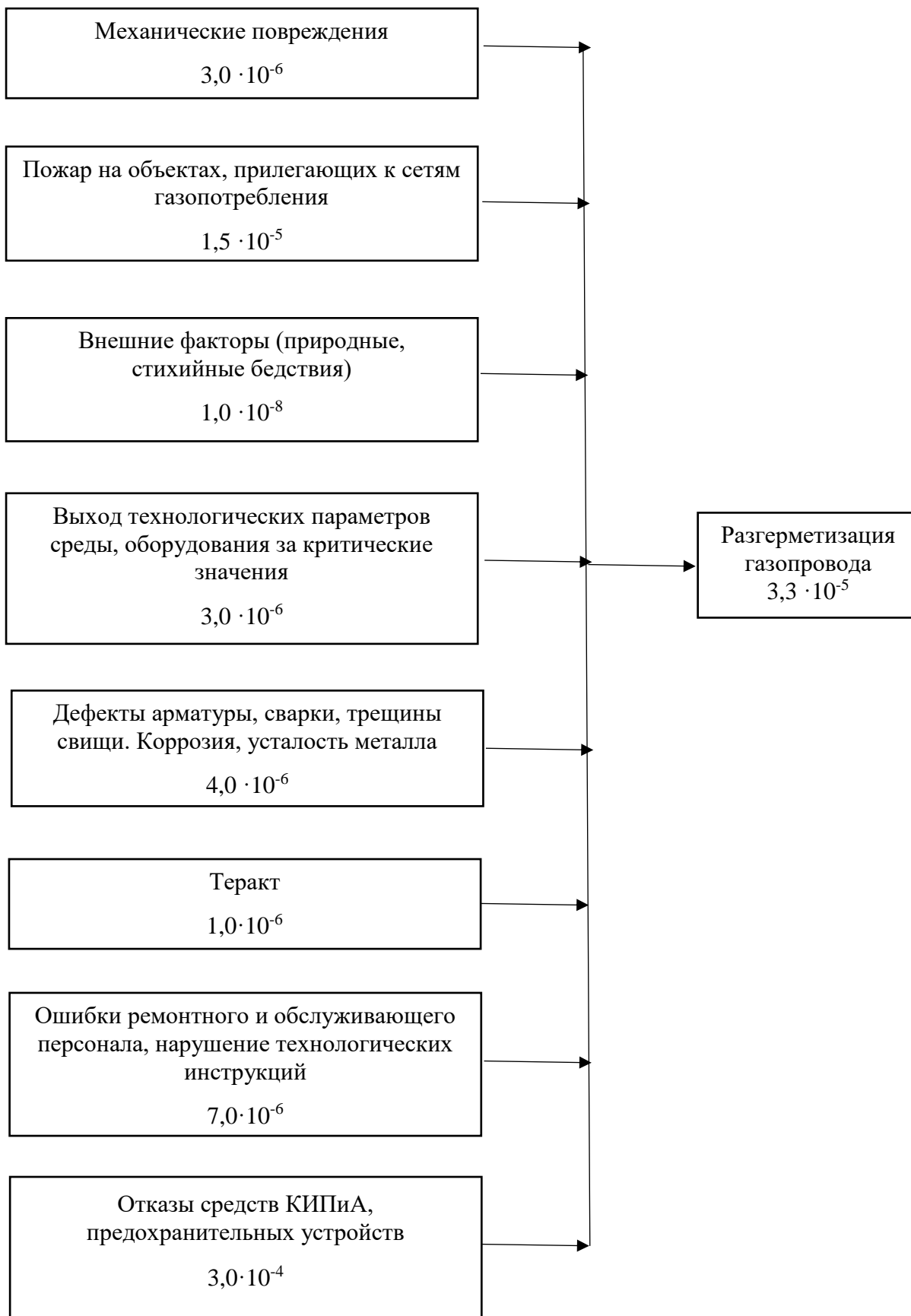
Рисунок 1 – Дерево отказов при работе газовой котельной
