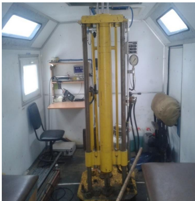
Рисунок 19 – Установка статического зондирования УСЗ 15/36 А (Фотография автора)
