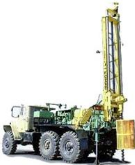
Рисунок 3.2. Буровая установка УГБ 1 ВС
