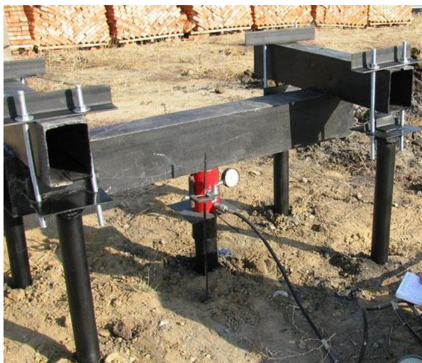
Рисунок 3.4. Конструкция эталонной сваи.
