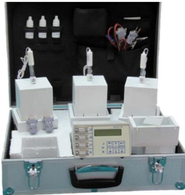
Рисунок 3.14 – Анализатор коррозионной активности грунта АКАГ-К
