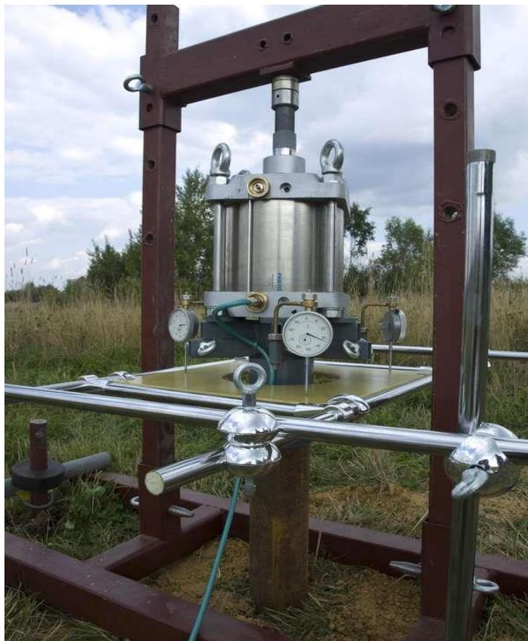
Рисунок 3.7 – Винтовой штамп ШВ-60
