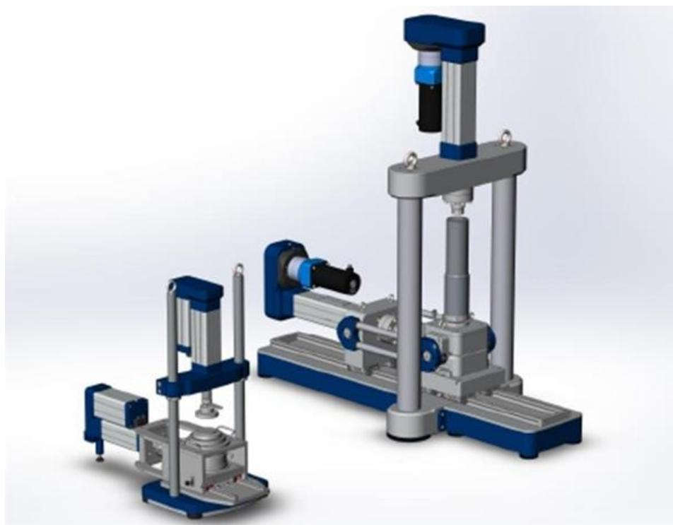
Рисунок 3.19 – Сдвиговые установки нагрузкой 100кН и 500кН
