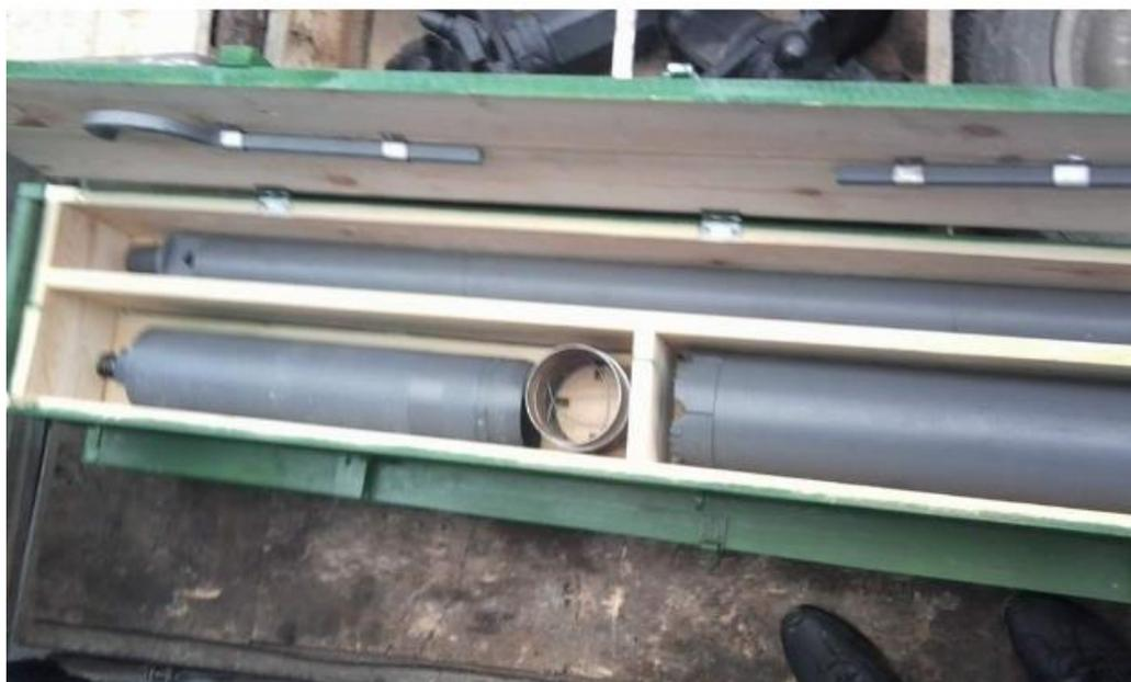
Рисунок 3.5 – Грунтонос вдавливаемый ГВ-3
