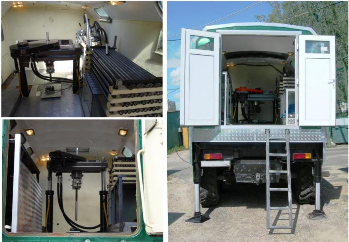
Рисунок 3.6 – Установка глубинного статического зондирования УГС-20
