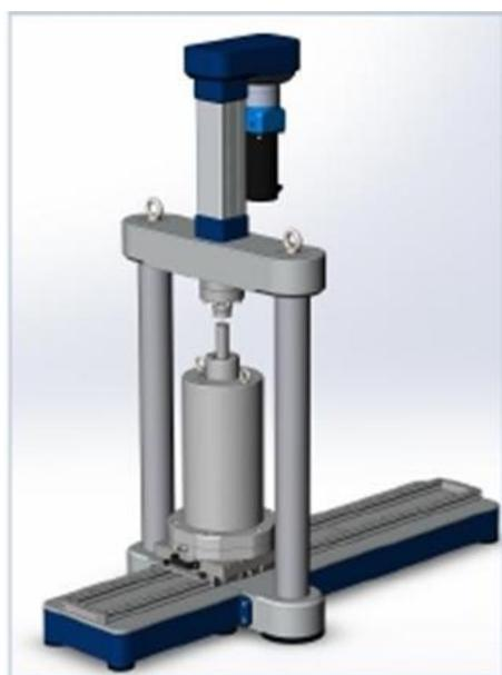
Рисунок 3.15 – Установка с камерой трёхосного сжатия
