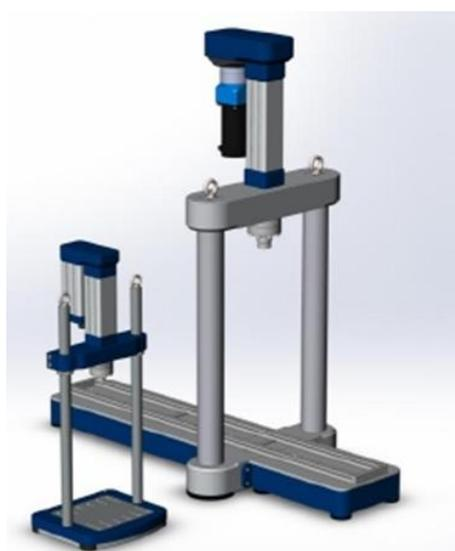
Рисунок 3.20 – Силовые рамы для установки на 100кН и 500кН
