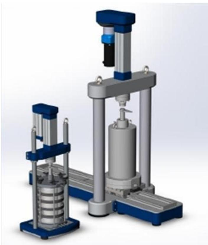
Рисунок 3.18 – Установки для испытаний образцов диаметром 150мм и 300мм
