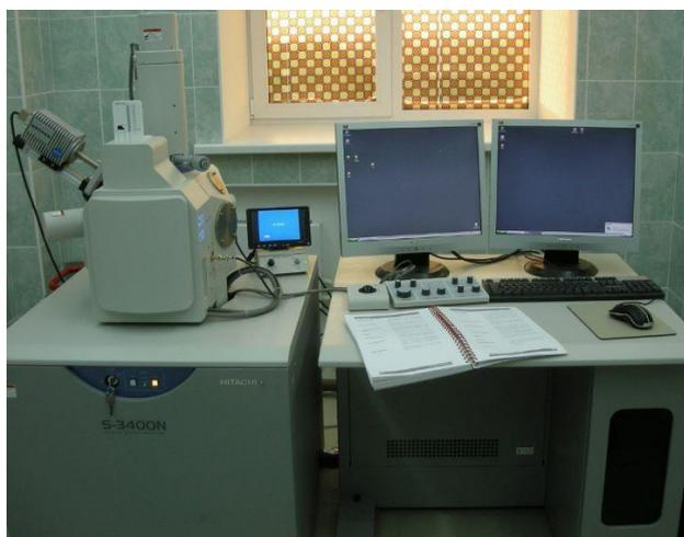
Рисунок 15 – Сканирующий электронный микроскоп Hitachi S-3400N [62]
