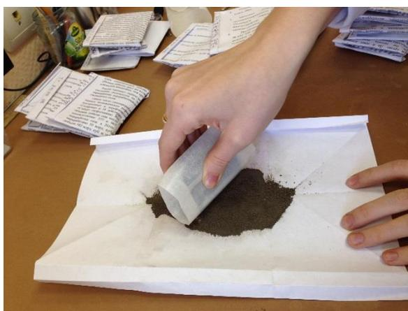
Рисунок 14 – Выделение магнитной фракции с помощью сильного магнита
