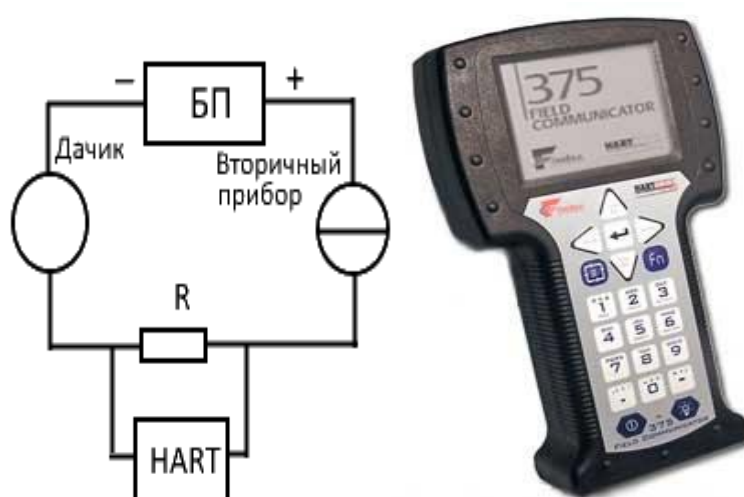
Рисунок 18. HART коммуникатор и схема подключения
