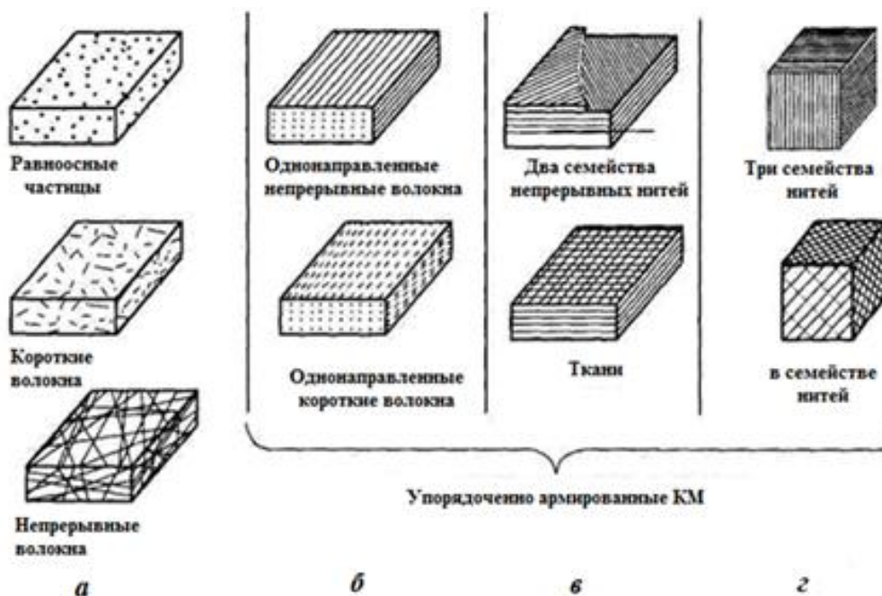
Рис. 1.1. Классификация композиционных материалов по конструкционному признаку: хаотично- (а), одномерно- и пространственно армированные (б – г)
