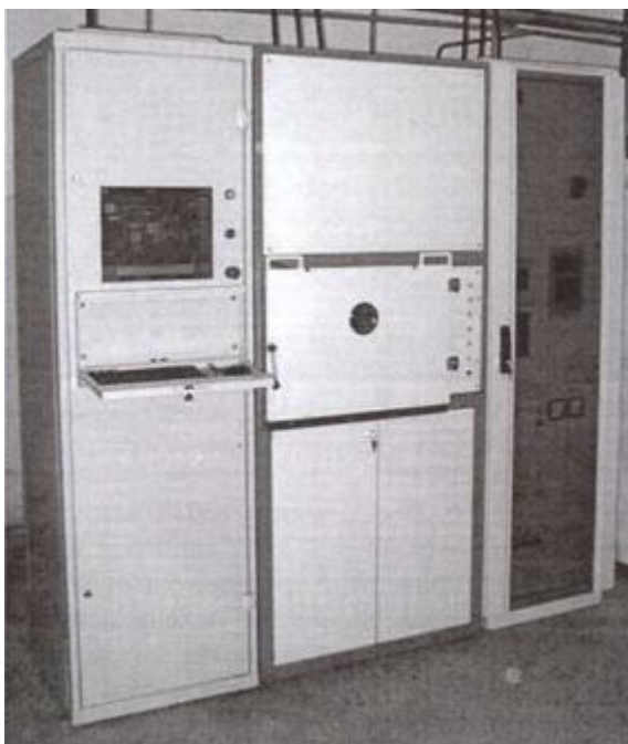
Рис. 2.26. Общий вид установки «СОЛО» для импульсной модификации поверхности металлов и сплавов, металлокерамических и керамических материалов электронным пучком[39].
