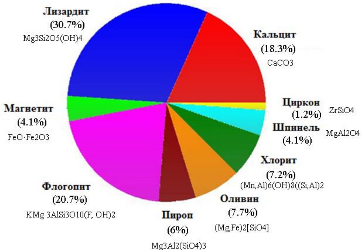
Рисунок 10 – Кимберлитовая брекчия. Содержание минералов в породе. Образец 590.
