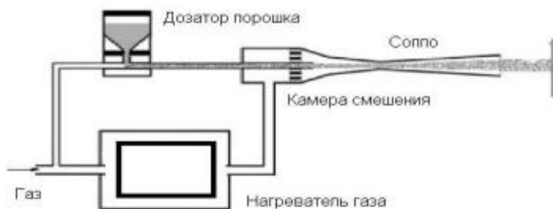
Рисунок 1.2 - Схема классической установки ХГН включает в себя газовый нагреватель, герметичный порошковый питатель и смесительную камеру сопло Лаваля.
