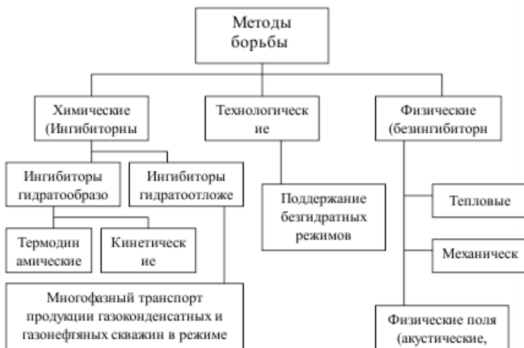
Рисунок 4.2 – Методы борьбы с техногенным гидратообразованием в газопромысловых и газотранспортных системах
