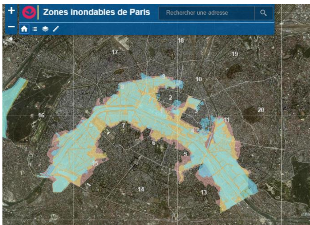
Рисунок 2.3 – Зона затопления Парижа 1910 года (голубым – пойма, розовым– зона затопленных подвалов, желтым– зона ненадёжного электроснабжения)
