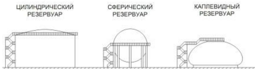
Рисунок 2 – Классификация резервуаров по форме
