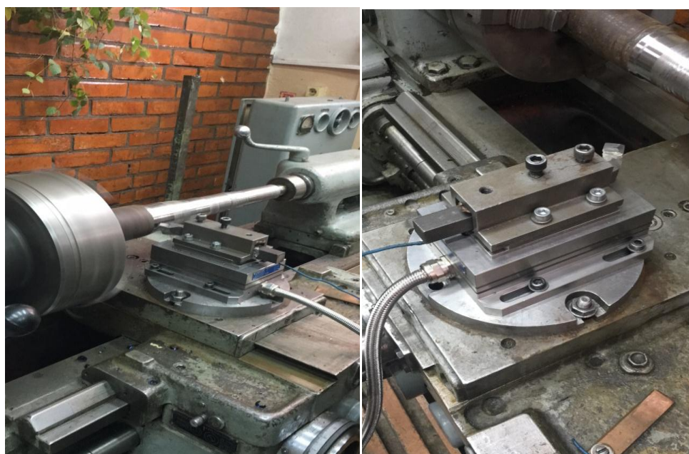
Рис. 5.1. Установка динамометра Kistler на токарном станке, настройка резца по высоте центров и его электроизоляция для измерения естественной термо-ЭДС
