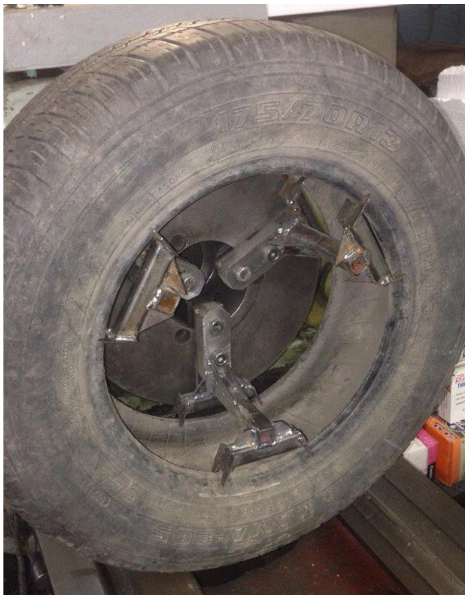
Рис. 2.5 – закреплённая в приспособлении шина
