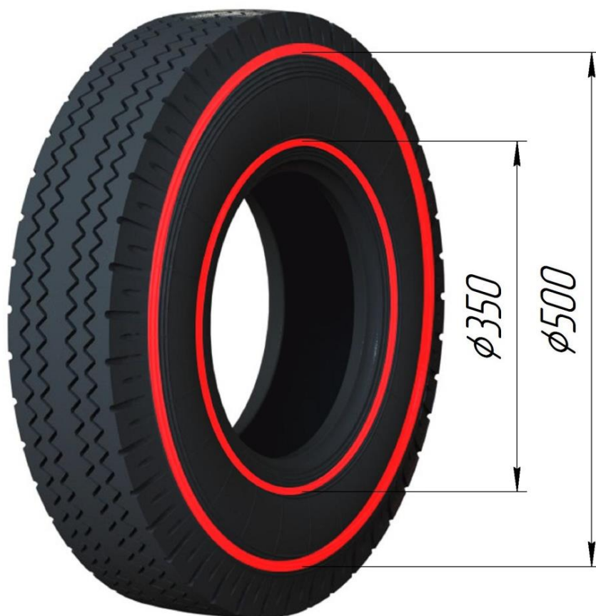
Рис.2.9 – диаметры вырезания боковой части шины
