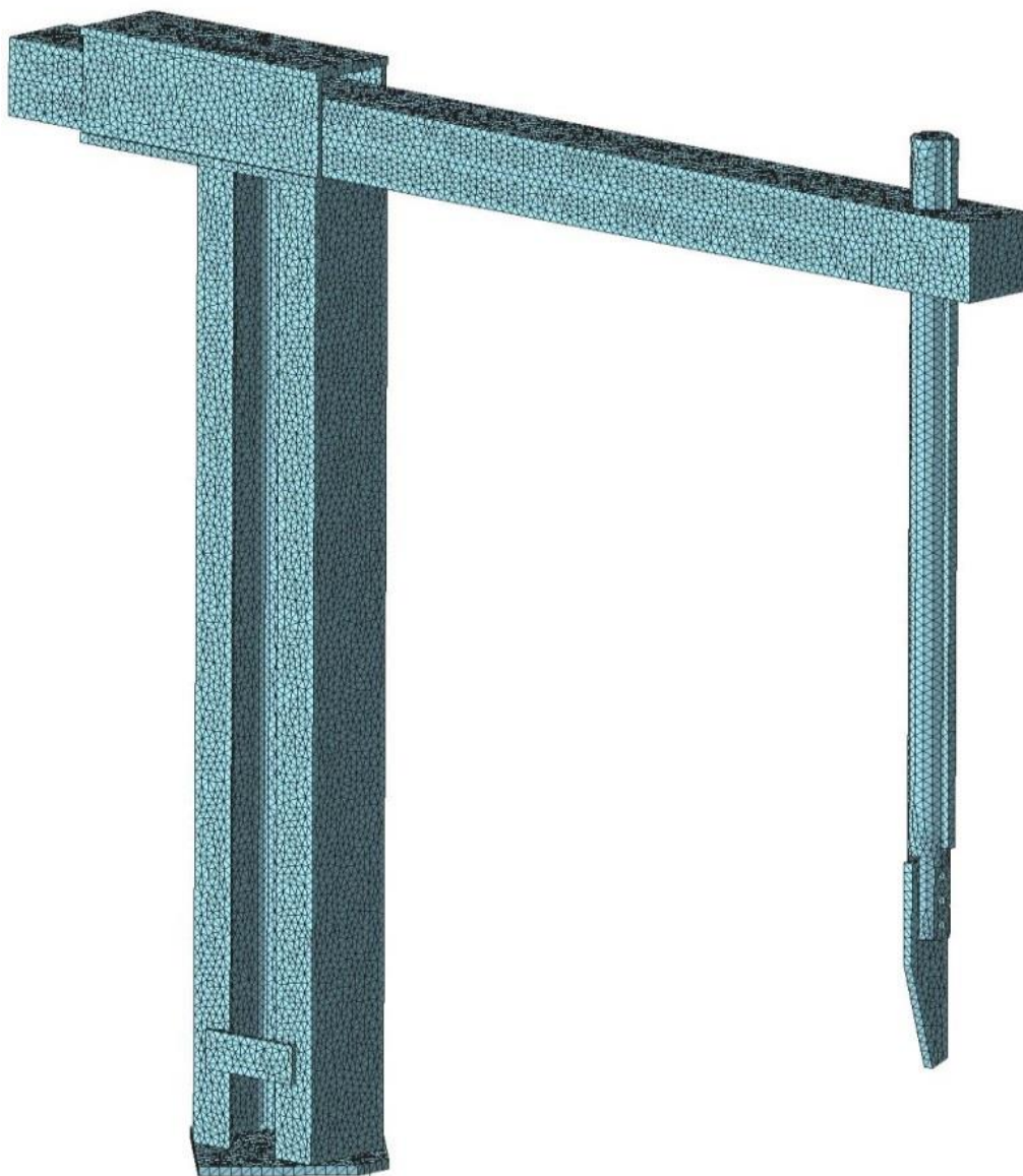
Рис.3.5 – разбиение модели методом конечных элементов
