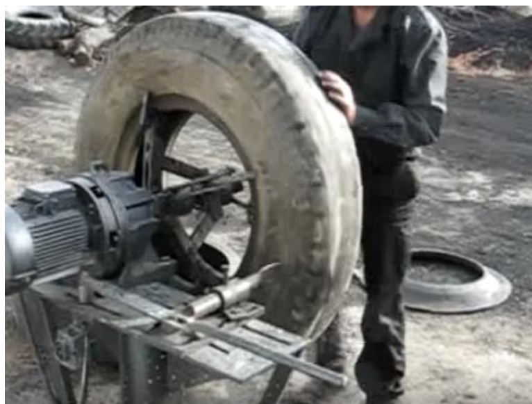
Рис. 1.7 – вырезатель боковых колец Fortan-2
