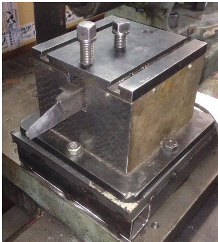
Рис.2.8 – установленный на суппорте станка динамометр с резцом
