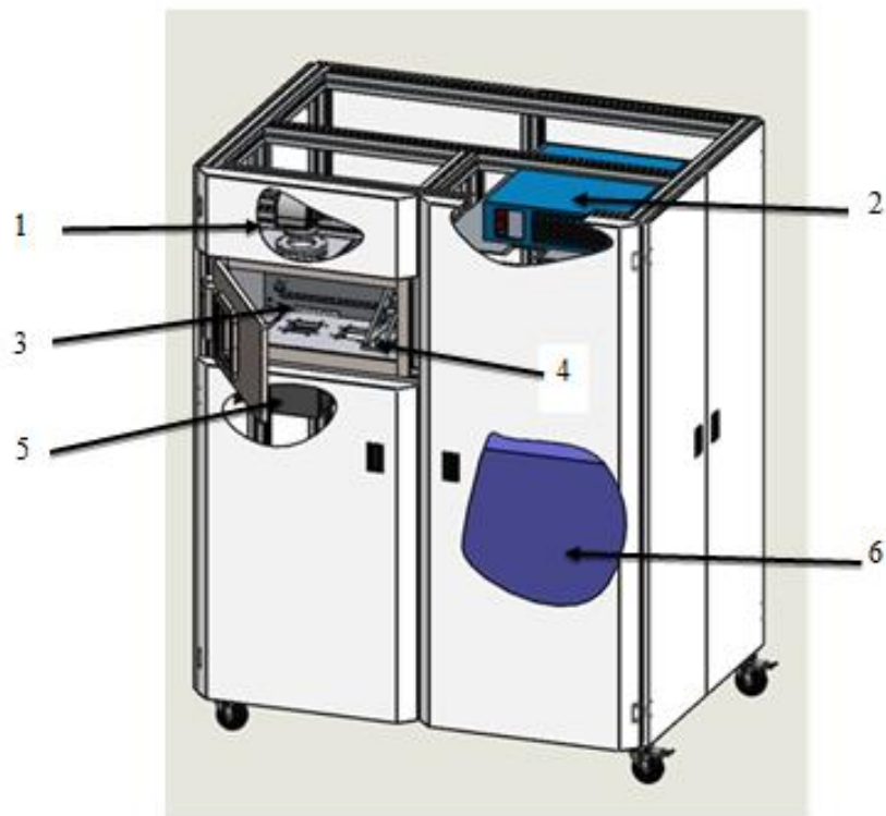
Рисунок 11 – Проект разработанной установки SLS печати
