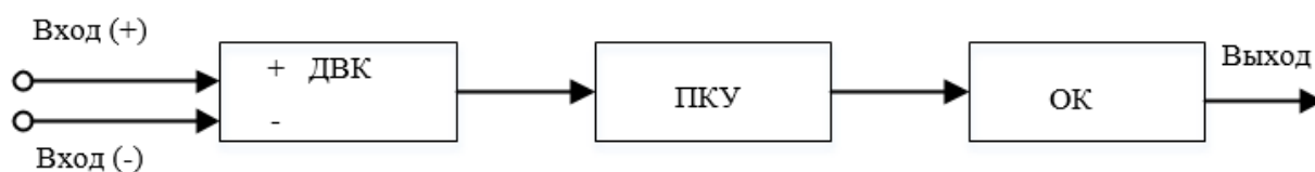
Рисунок 2.1 – Структурная схема операционного усилителя
