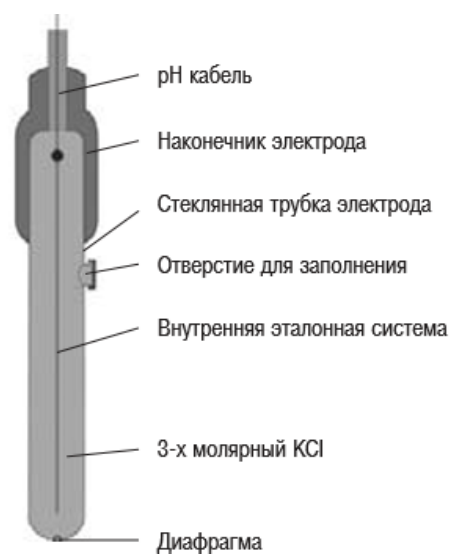
Рисунок 8 – Конструкция электрода сравнения с электролитом
