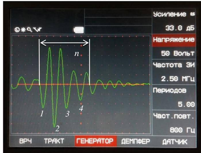
Рисунок 3.4 – Фотография экрана дефектоскопа с огибающей эхо-импульса на частоте 2,5 МГц
