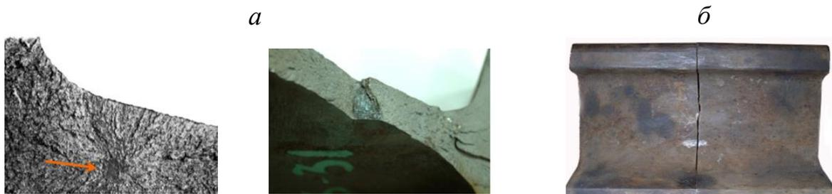
Рисунок 1.14 – Фотографии излома от непровара (контактная сварка): а– виды в изломе (в пере подошвы и в шейке); б – общий вид
