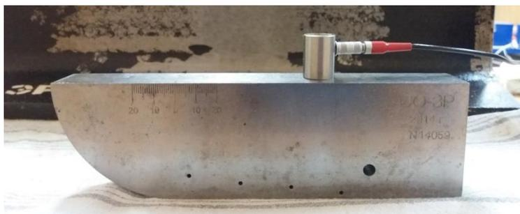
Рисунок 3.2 – Установка ПЭП на СОП-3Р
