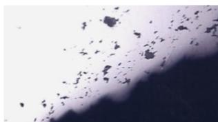
Рисунок 1.19 – Фотография микроструктуры: силикаты в зоне излома ( $\times 100$ )
