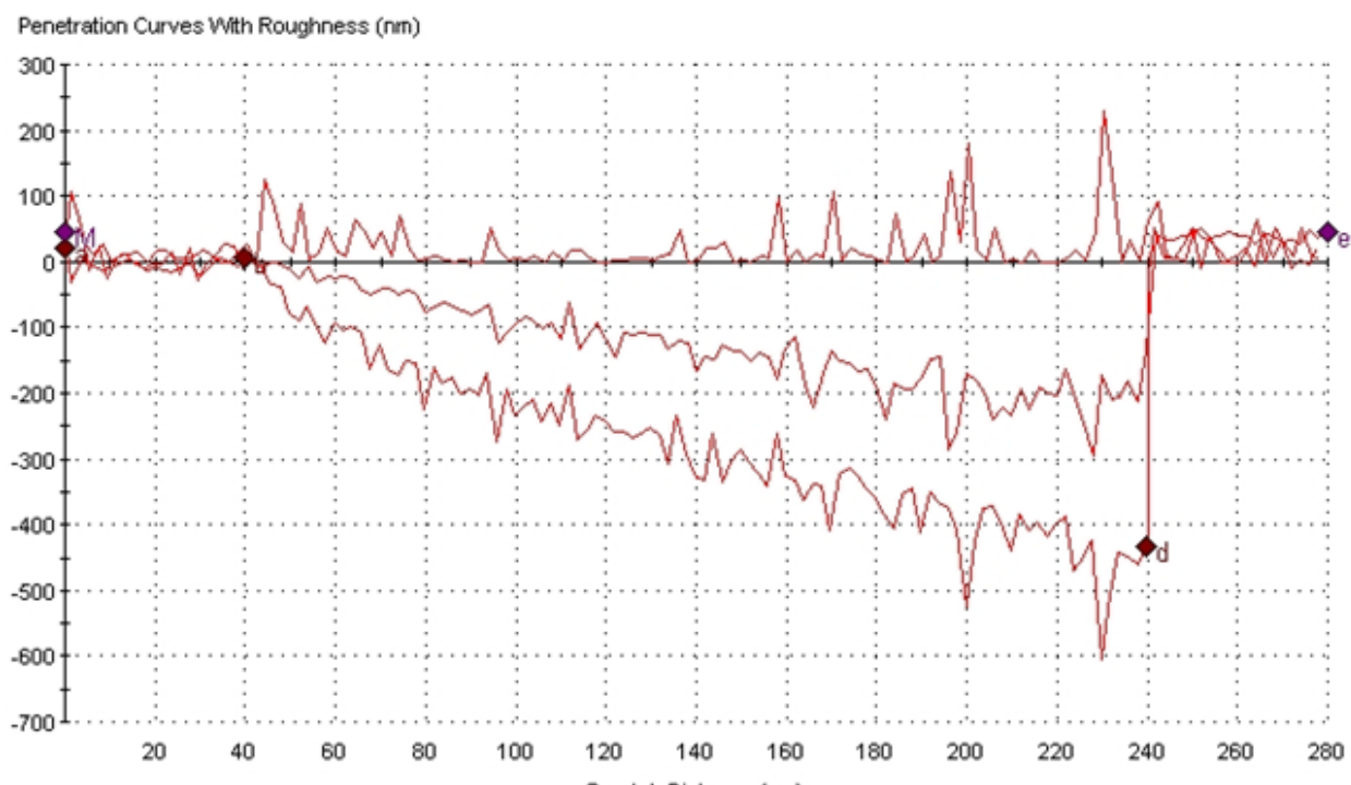
Рисунок 15 - Результаты скрѣч-тестинга керамики состава ZrO_2-5\% Y_2O_3 (по длине)
