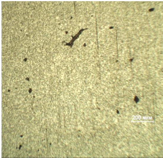
Рисунок 26 – Микроструктура керамики состава ZrO_2 - 5\% Y_2O_3 (Печное спекание, обработка в азотсодержащей плазме при температуре 1400^\circ C )
