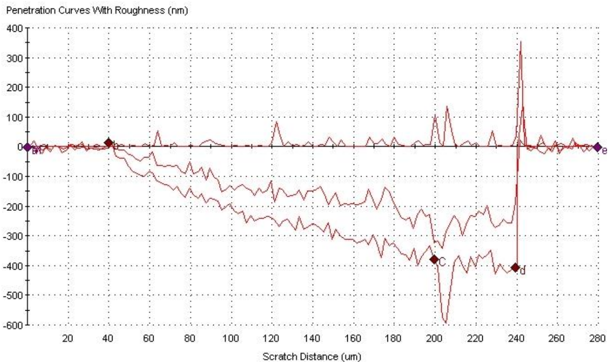
Рисунок 22 – Профиль царапины, полученной с помощью скрэч-тестинга керамики состава 80% \text{Al}_2\text{O}_3 – 19% \text{ZrO}_2 – 1% \text{Y}_2\text{O}_3
