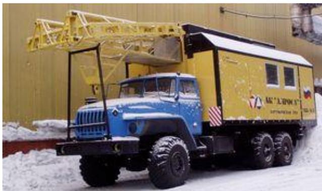
Рисунок 2.2 – Буровая установка УКБ-5С
