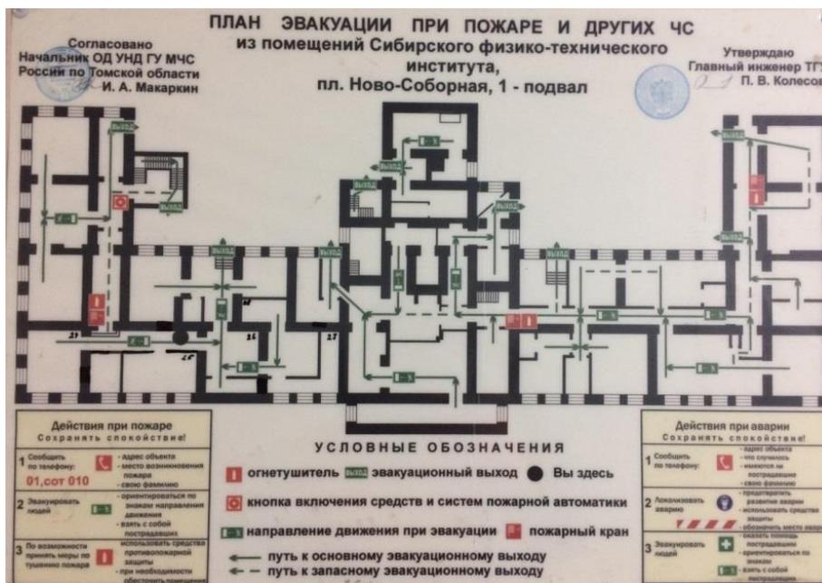
Рисунок 19 – План эвакуации из помещения Сибирского физико-технического института, пл. Ново-Соборная, 1 – подвал
