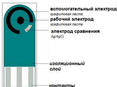
Рисунок 5 – Внешний вид электрода, изготовленного методом трафаретной печати
